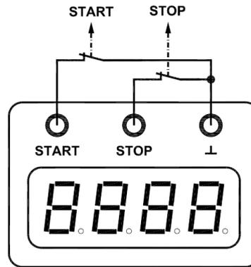
Fig. 1 Représentation schématique de la connexion des entrées
