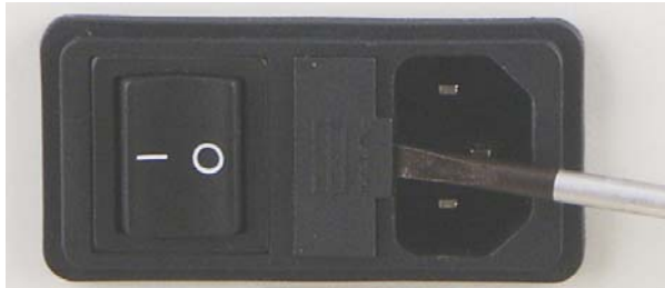
Fig. 3: Troca de fusíveis
