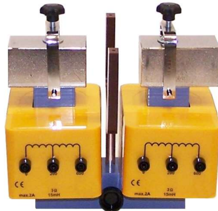
Fig. 4: Montagem sobre núcleo em U com bobinas, sapatas polares e suporte em U
