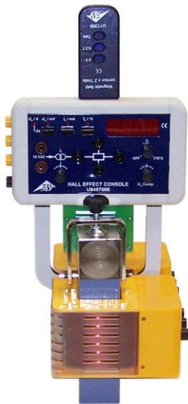
Fig.8 Vue de face du montage du capteur de champ magnétique
