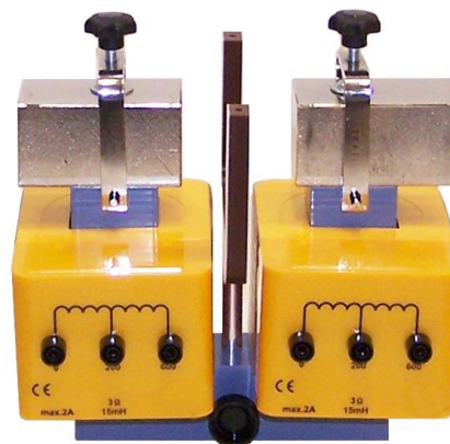
Fig. 4 Montage sur le noyau en U avec les bobines, les épanouissements polaires et le support en U
