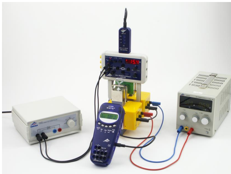
Fig. 9 Montage expérimental sur l'effet Hall avec champ magnétique homogène
