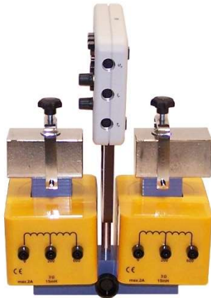
Fig. 6: Aparato base encajado en el soporte en U
