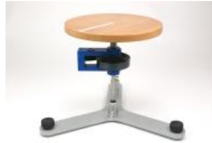
Fig. 4 Determinação do momento de inércia de um disco de madeira
