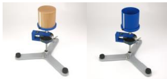
Fig. 5 Comparação dos momentos de inércia de cilindros
