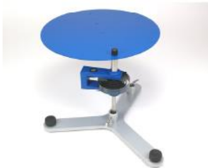
Fig. 7 Confirmação do teorema de Steiner
