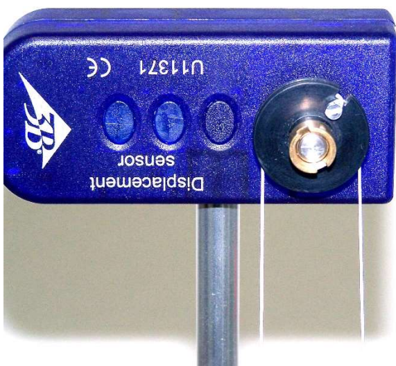
Fig. 3: Condução do fio em volta do rolo
