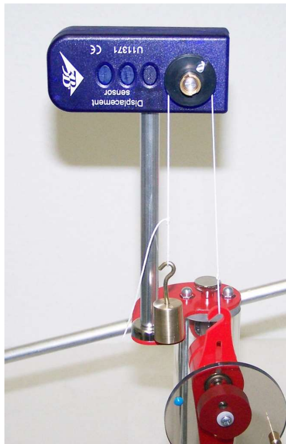
Fig. 5: Fixação do fio no entalho do excêntrico
