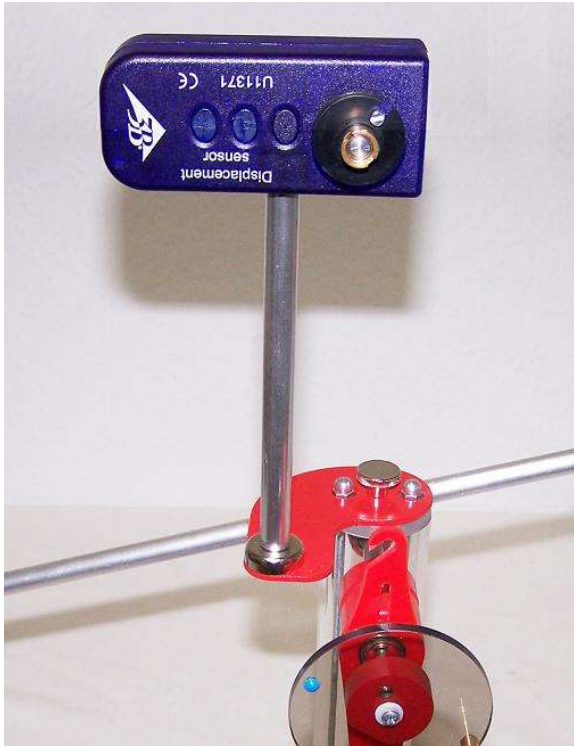
Fig. 2: Montagem do sensor de distância
