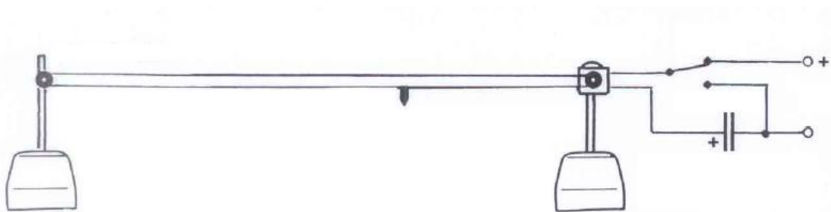
Abb. 5: Energie in einem Kondensator (zugeführte Energie gleich abgegebener Energie)
