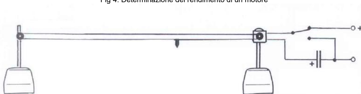
Fig. 5: Energia in un condensatore (energia apportata uguale energia rilasciata)
