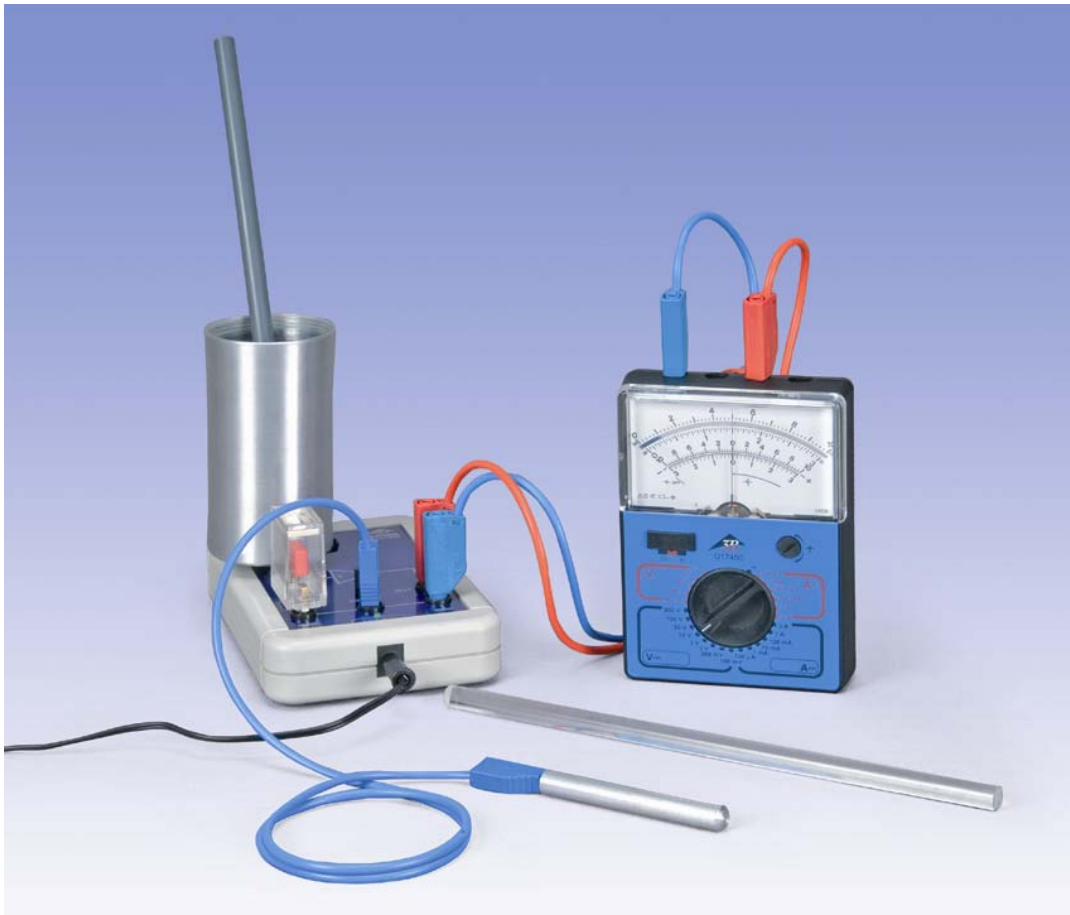
Fig. 1 Montagem de experiência para a medição de cargas na eletrostática
