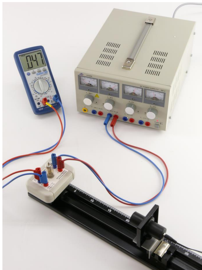
Fig. 2 Montagem da experiência para a comprovação do efeito fotoelétrico
