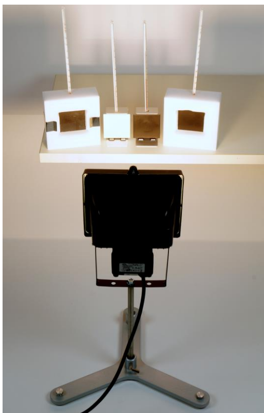
Fig. 1 Montaje experimental con lámpara halógena
