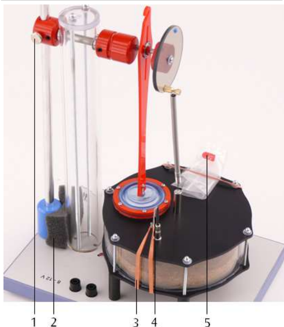
Fig. 7: Motor Stirling em condições protegidas
