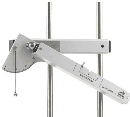
Fig. 2 Montagem da experiência do lançamento diagonal
