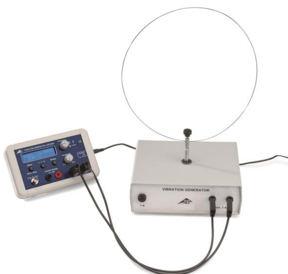
Fig. 3 Montagem da experiência com o fio de ressonância
