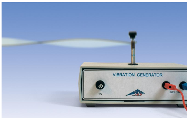
Fig 1 Montagem da experiência com a tira de borracha
