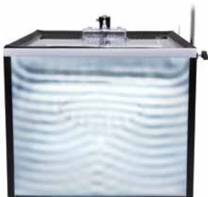
Reflexão de ondas de água num espelho côncavo
