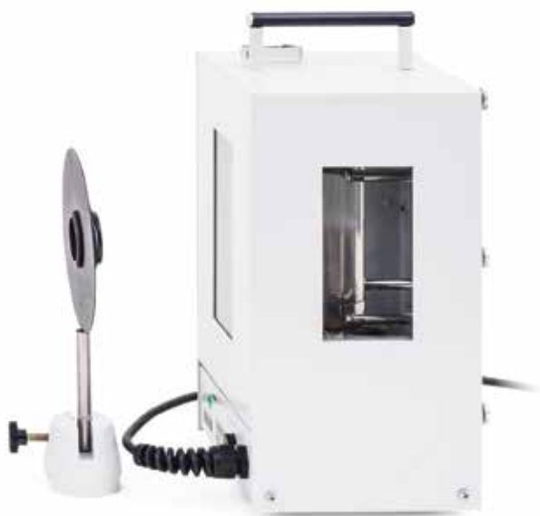
Montagem da experiência para iluminação do tubo de fluorescência de sódio com luz branca focada.
