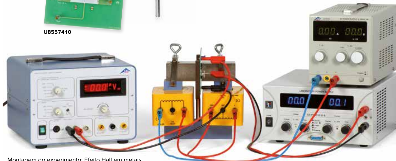
Montagem do experimento: Efeito Hall em metais
