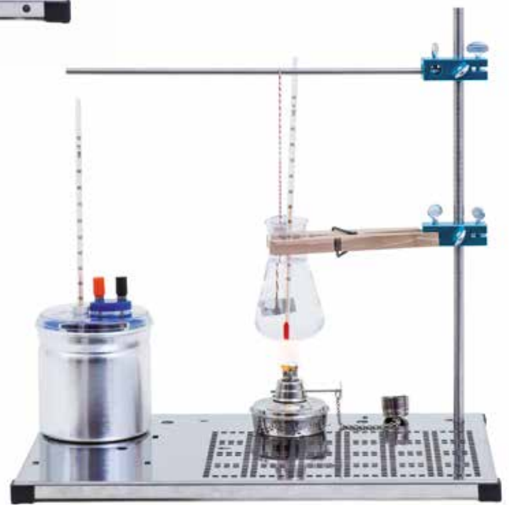
Capacidade térmica específica dos metais
