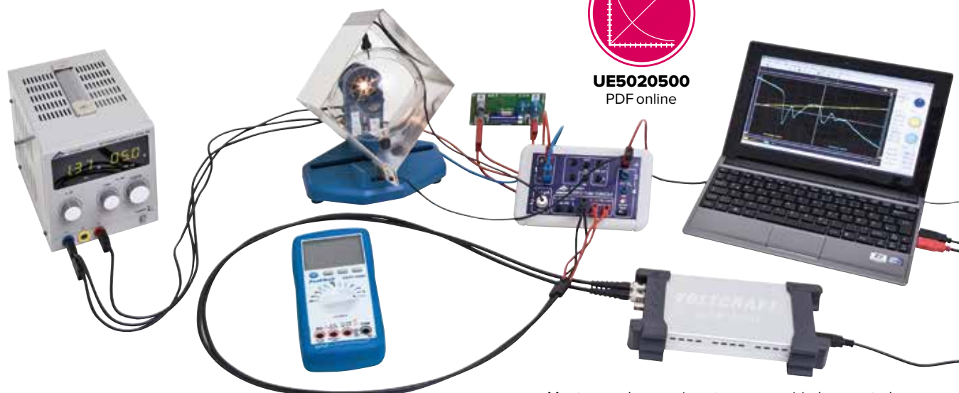
Montagem do experimento com a unidade e controle para tubos de potenciais críticos
