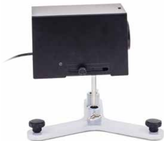
Montagem da experiência para iluminação do tubo de fluorescência de sódio com luz branca focada.
