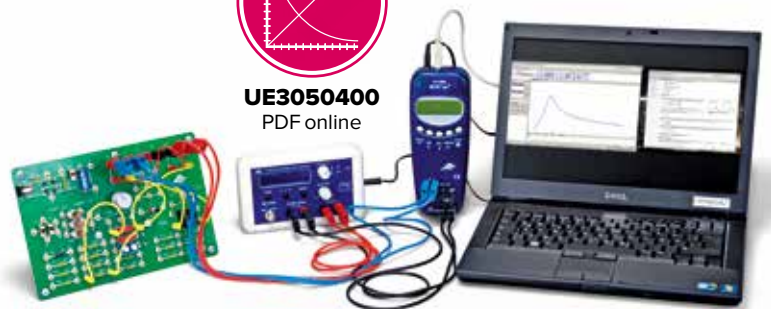
Desenho da curva de ressonância de um circuito em série RLC
