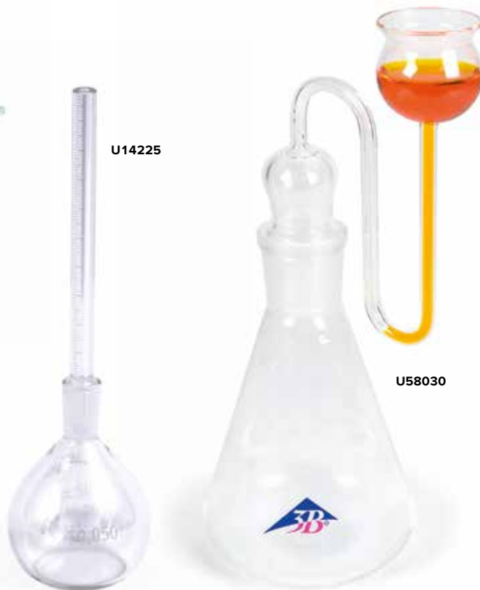
Determinação da densidade máxima da água
