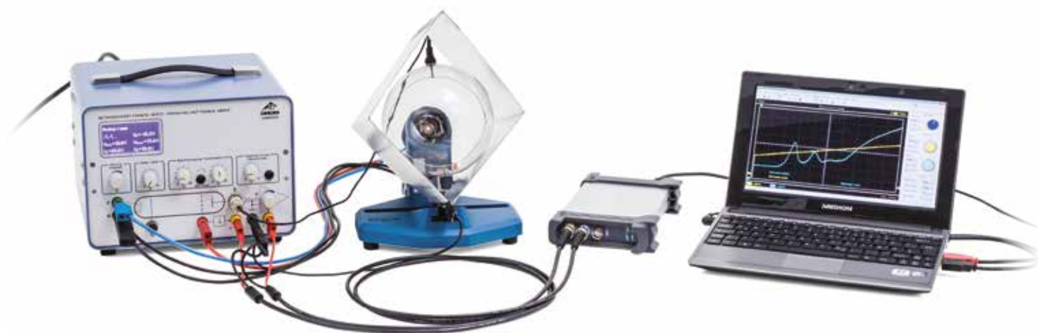
Montagem do experimento com o aparelho para o experimento de Franck-Hertz
