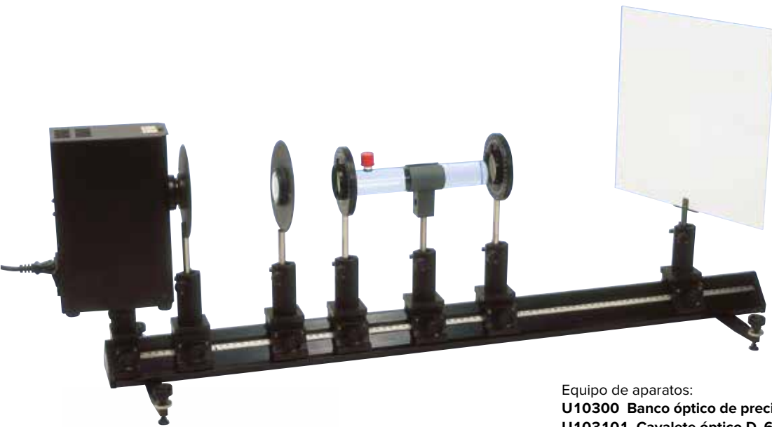
Determinação do ângulo de rotação de substâncias de opticamente ativa
