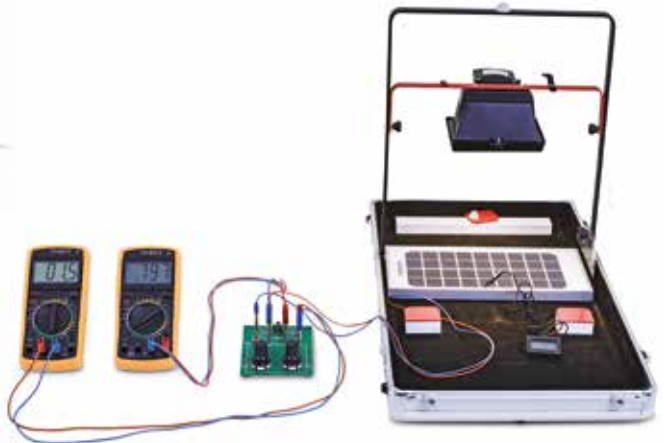
Dependência da temperatura da potência de módulos solares
