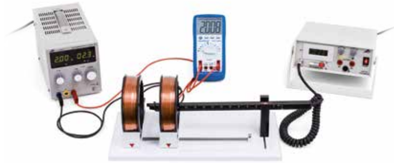
medição do campo magnético em um par de bobinas com distância variável
