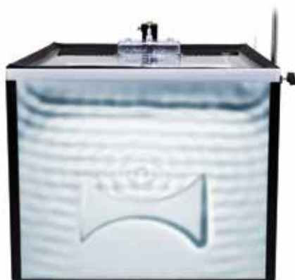
Refração de ondas de água sobre uma lente convergente
