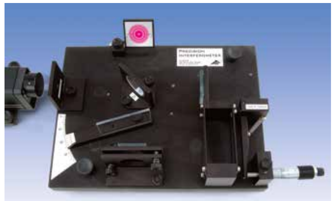
Lastra di vetro sul percorso dei raggi dell'interferometro di Michelson
