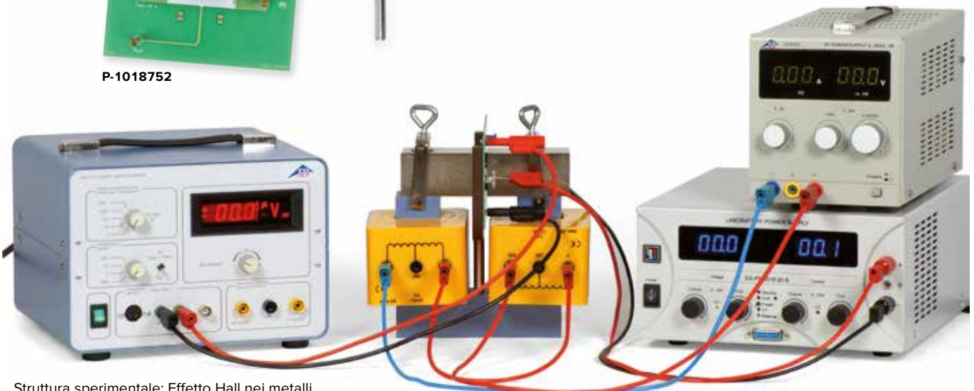
Struttura sperimentale: Effetto Hall nei metalli
