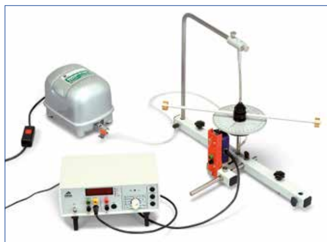
Misurazione dei periodi delle oscillazioni di torsione armoniche con un contatore digitale
