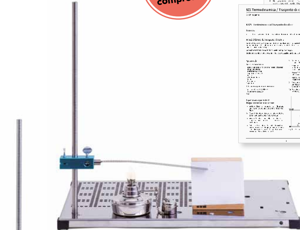
Analisi sulla striscia bimetallica
