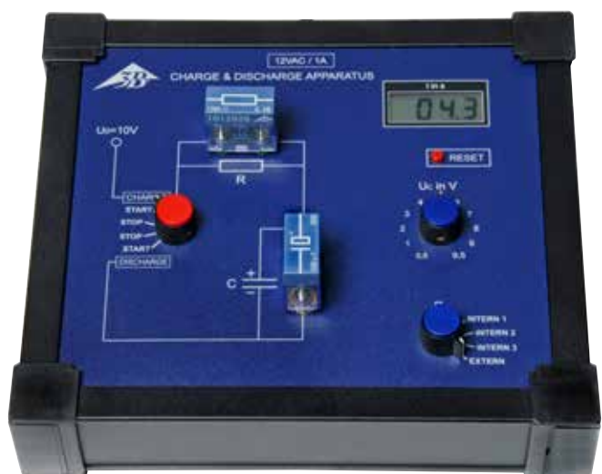
Misurazione nella coppia RC esterna
