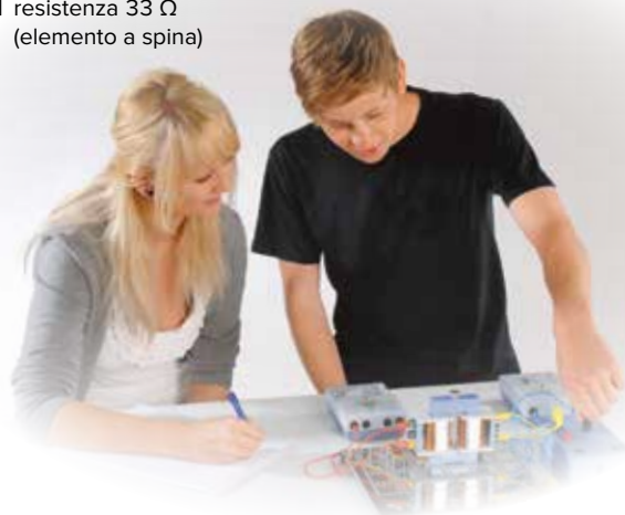
Trasformatore sotto carico
