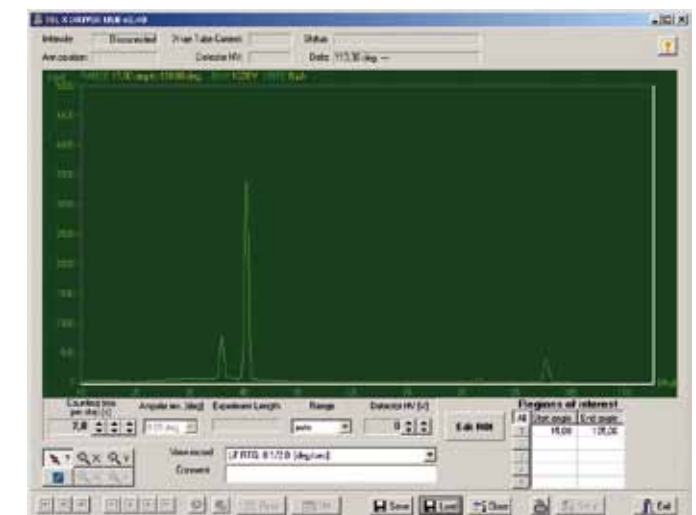
Fig. 3: Curva de Bragg para el NaCl
