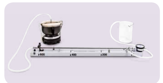
Fig. 3: Montaje con generador de vapor
