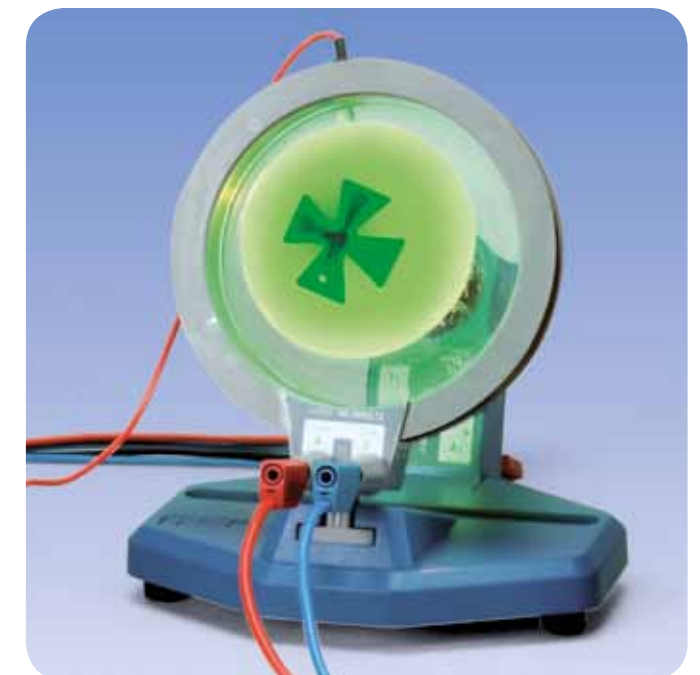
Fig. 2: Giro de la sombra de los electrones producido por su desviación en el campo magnético axial
