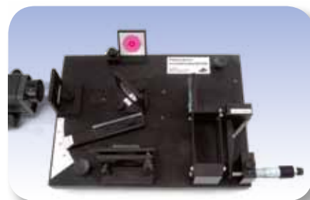
Placa de vidrio en la trayectoria del haz del interferómetro de Michelson
