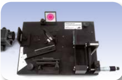
Michelson-girişimölçerinin demet yolundaki cam düzlem
