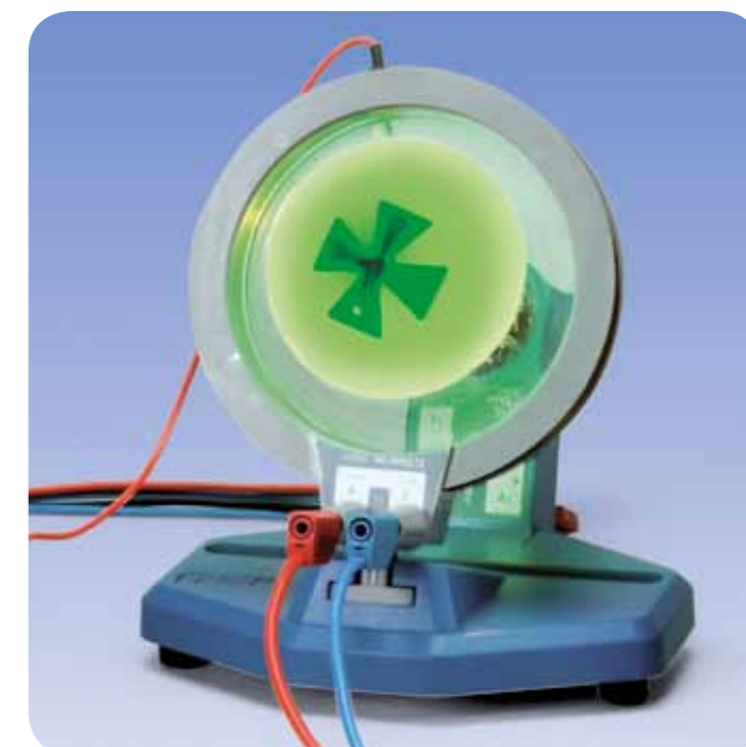
Fig. 2: Rotação da sombra de elétrons por meio do desvio de elétrons num campo magnético axial
