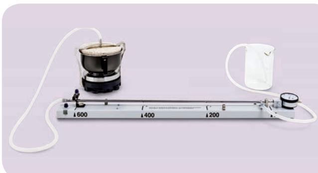
图3: 蒸气发生器装置图
