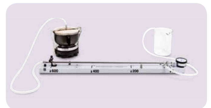
Fig. 3: Montagem com gerador de vapor
